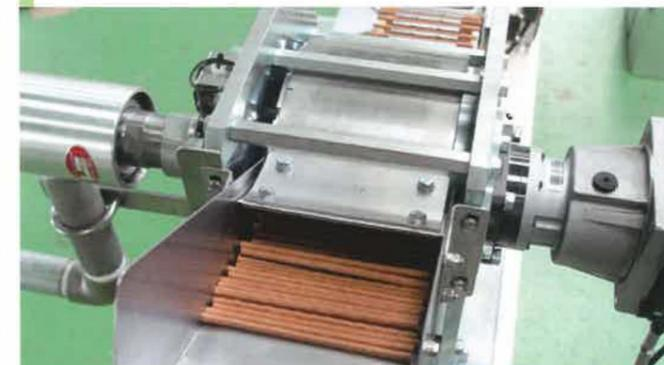
供給コンベア上に、製品が供給されなかった場合に 0.05 秒で補給する
