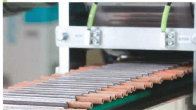
充填を正確にするため、1本ずつ整列させて供給する
