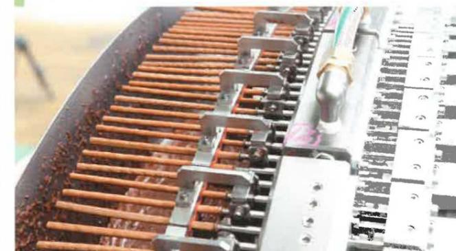
片側より約 3 秒で充填が完了する
